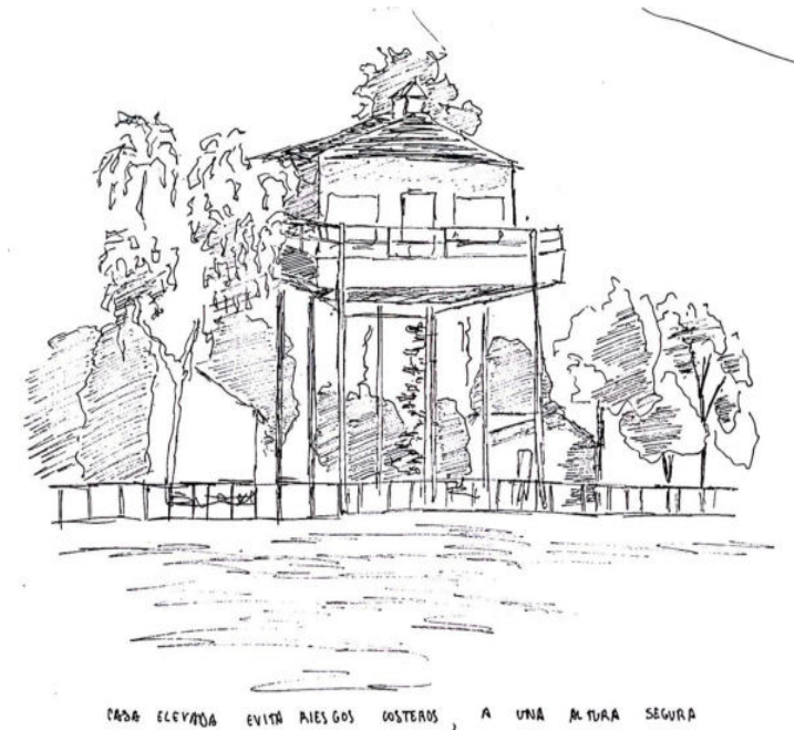
Croquis 45. Casa elevada a una altura segura ante cualquier evento de riesgo costero. Adaptabilidad al espacio para lograr una vivienda definitiva.
