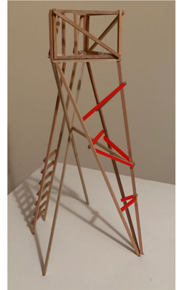
Imagen 73. Estructura terminada. Palitos en color rojo unifican las diagonales para darle mayor resistencia.
