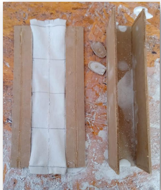
Molde luego de desmoldar la viga.
