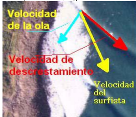
Figura 4. Trayectorias seguidas por el frente de descrestamiento de ola y el punto de la ola. (“peel angle”)
