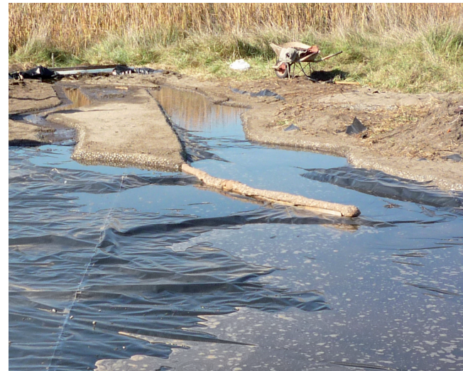
Modelo a escala reducida del puerto con los dos canales: salida del río y brazo de mar.
