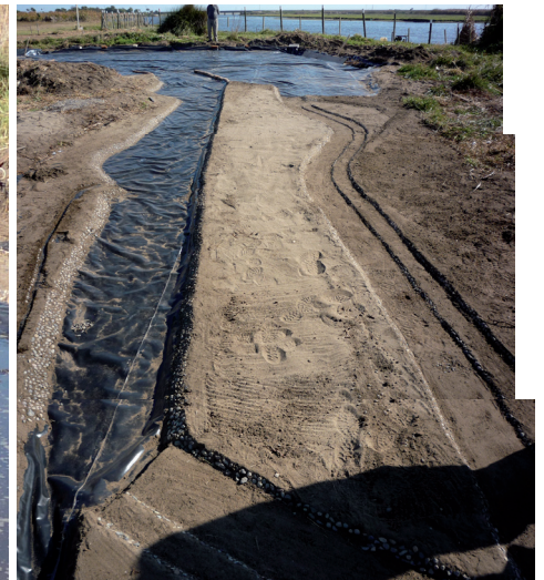
Modelo a escala reducida del puerto con los dos canales: salida del río y brazo de mar.
