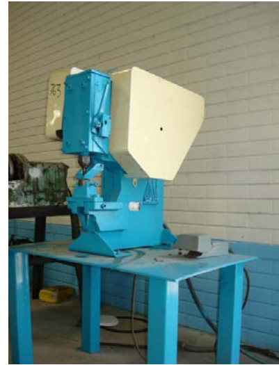
Troqueladora - Medio impresor - imprime rasgos en el material aluminio. Ejemplo: fabricación de copas para latas de bebida.
