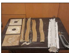
Despegar los trupanés, tela, y siliconas uno del otro con cuidado asistiendo del cartonero y la regla metálica. Despegar la tela del yeso con cuidado.
