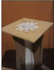
Estirar un extremo de la tela, cortarlo con tijeras para formar pestañas y pegarlas con Agorex al trupan. Hacerlo en ambos extremos, teniendo cuidado de que la tela quede correctamente estirada.
