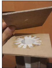
Marcar al centro de la base un pequeño agujero pero sin atravesarlo con el cartonero, para usarlo de guía para el alambre. Pegar tapando un extremo.
