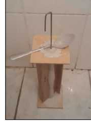
Agua sale por la tela, por lo que el volumen baja y hay que vaciar un poco más de mezcla, repetir cuanto sea necesario. Cuando frague dejar secar dos días en un lugar seco.
