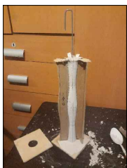
Quitar el yeso que se rebalsó y despegar las pestañas con cuidado del trupan, asistiendo de la regla metálica.
