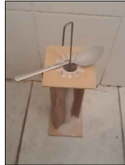
Vaciar la mezcla en el moldaje. Mantener el alambre centrado en el círculo con la misma cuchara.
