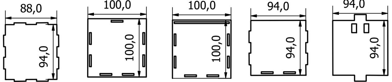
Cubo de seis piezas de terciado de un grosor de 3mm.
