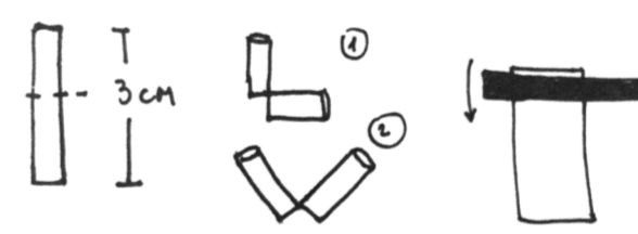
CONECTORES El palo de coligüe es enrollado en el cartón para formar los cilindros
