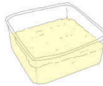
Mezcla homogénea de yeso y agua
