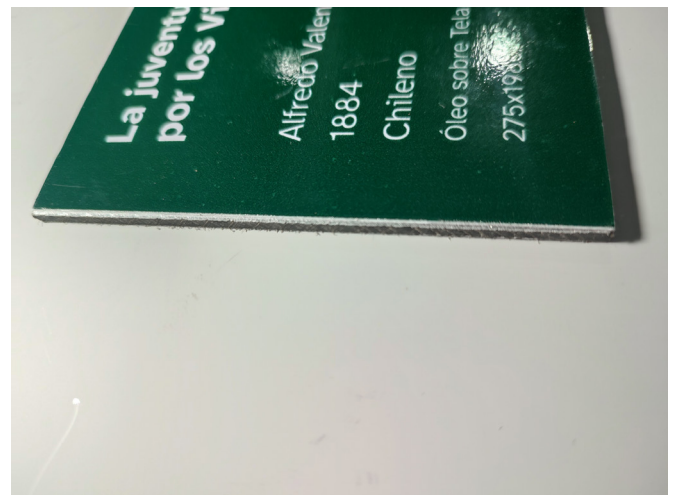
Fig.89. Error de Corte 2 Rótulo Obra. Elaboración Propia.
