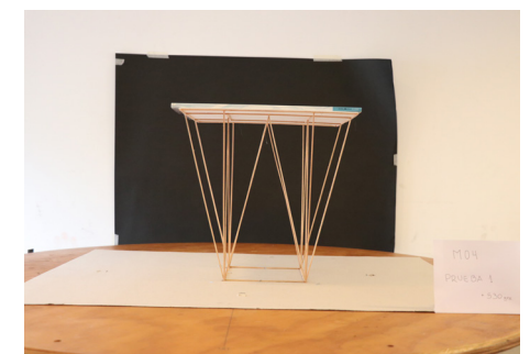
fotografías de pruebas de modelos en mesa oscilatoria
