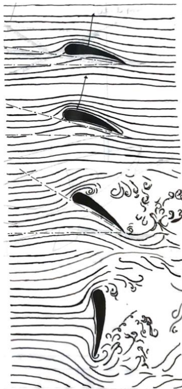
Figura 8 - Incidencia del ángulo de ataque en la relación de sustentación y arrastre
