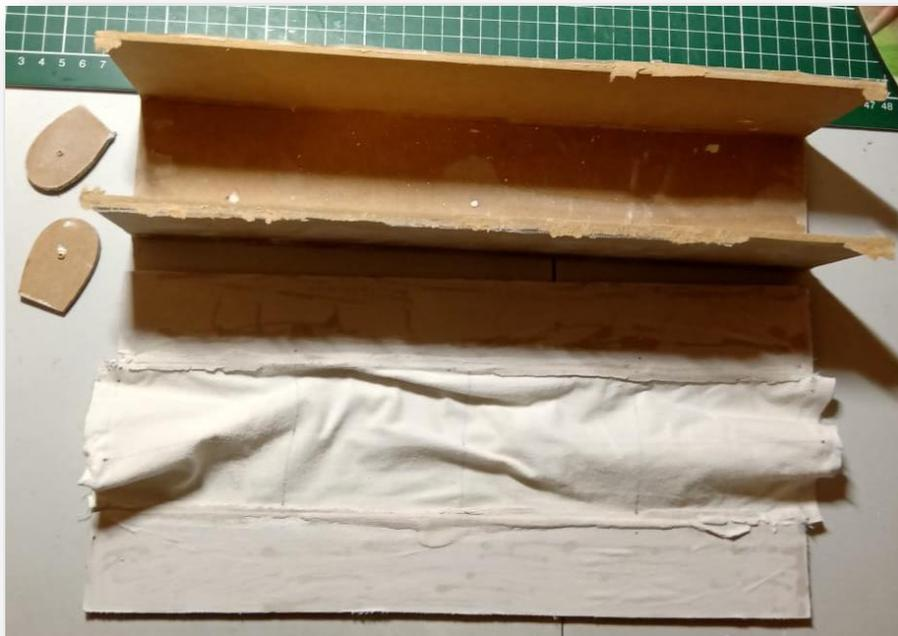
MOLDE UNA VEZ DESMOLDADA LA VIGA.
