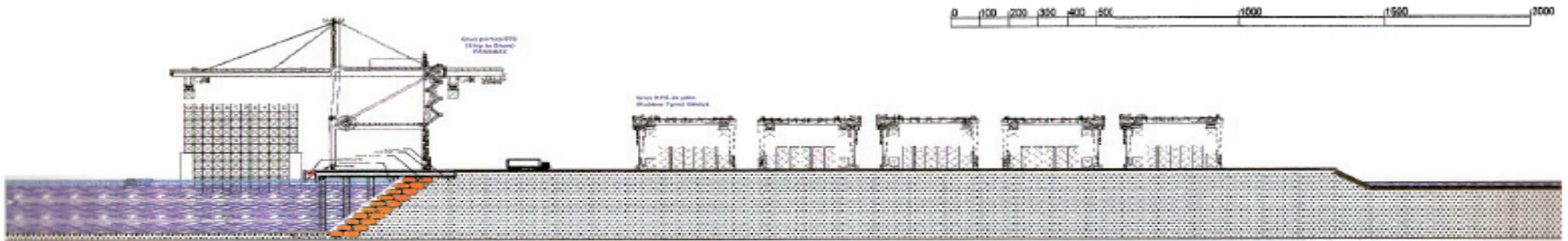
Corte transversal del puerto con los dos canales: salida del río y brazo de mar.
